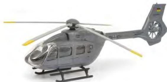
• Der H145M ist ein leichter Mehrzweckhubschrauber zum Transport von Spezialkräften. Aufgrund seines ummantelten Heckrotors ist der H145M einer der leisesten Hubschrauber weltweit. Mit seinem speziell entwickelten Design und den geringen Außenflächen ist der H145M hervorragend dafür geeignet, Spezialkräfte möglichst unauffällig an Ihren Einsatzort zu bringen und dort abzuseilen. Aufgrund seines recht kleinen Rotordurchmessers ist dies auch in urbaner Umgebung möglich.
